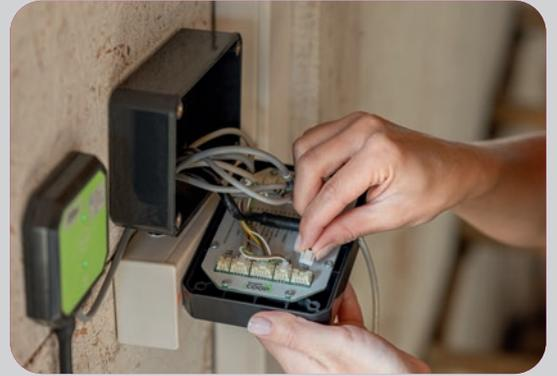
Das **Connectivity-Modul (Art. 70620)** verbindet die Steuerung mit dem lokalen WLAN und ermöglicht die Programmierung und Überwachung aller Funktionen voll digital über die „Kerbl-App“.
