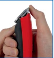
**Wichtig: damit der Schwinghebel in den Scherkopf einrasten kann, muss die Maschine eingeschaltet werden.**
