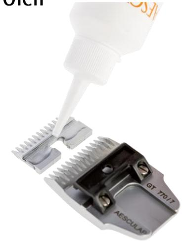
Auf die besonders sorgfältige Reinigung der Zahnlücken ist zu achten. Bei Verwendung von Desinfektionsmitteln sind die Scherköpfe gründlich zu trocknen, um Korrosion zu vermeiden. Nach dem Reinigen sind die Scherköpfe einzuölen.
