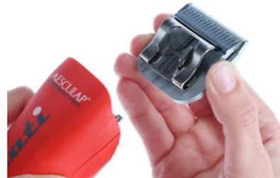
Sollte das Messerscharnier versehentlich angeklappt sein, kann dies mittels eines Schraubendrehers wieder gelöst werden.
